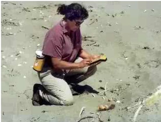
Il ricevitore registra insieme alla posizione (coordinate) dei punti una serie di informazioni associate, ad esempio un codice identificativo utile a collegare ulteriori dati.
