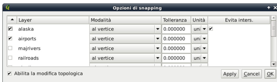
Figura 4.25.: Modifica delle opzioni di snapping per singoli layer
